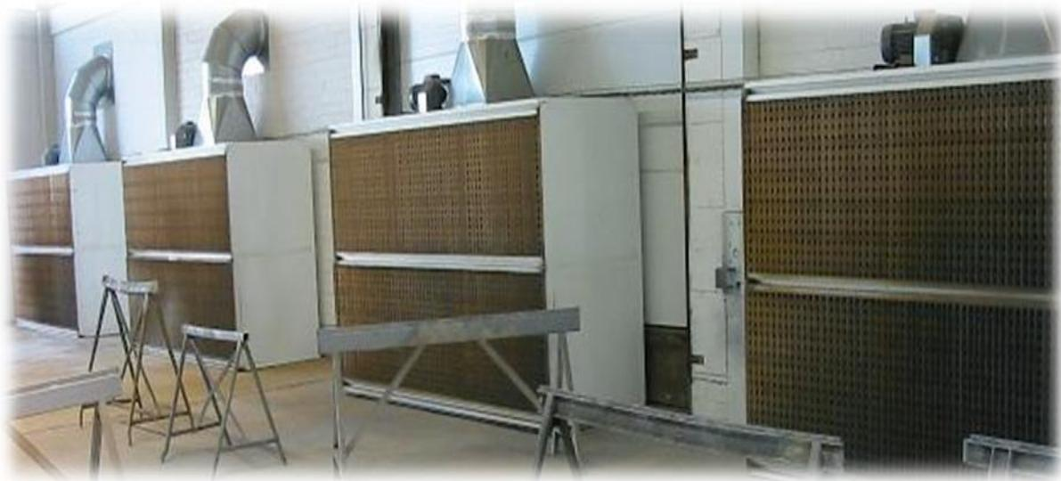
Elles sont destinées à répondre aux demandes des ateliers, où l'application d'apprêt, de peinture, de vernis, de résine, ou de mousse est nécessaire. Elles permettent aussi d'éviter d'immobiliser la cabine principale de peinture pour les phases d'apprêtage ou de laquage de finition pour des pièces de petit et moyen gabarit.
