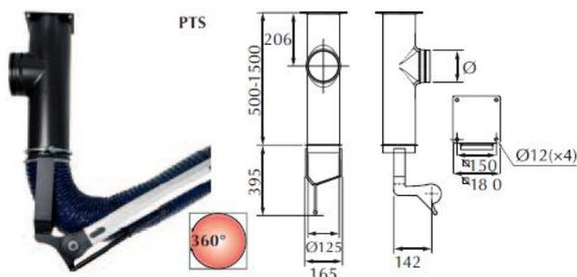
Fixation plafonnrière pour extracteur type PR dans les long. 1,5 ; 2 et 3 m
