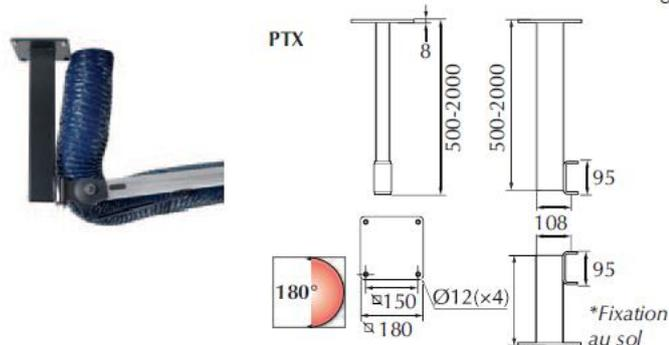
Fixation plafonnrière et sol pour extracteur type PR en 1,5 ; 2 ; 3 et 4 m
